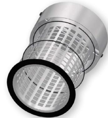
Filterkorb als Laserzuschnitt für Aufnahme der Filtermatte. Diese wird mittels Spannringen oder Klettverschlüssen fixiert. Unten mit Dichtprofil – somit kein Ansaugen von ungefilterter Außenluft möglich.
