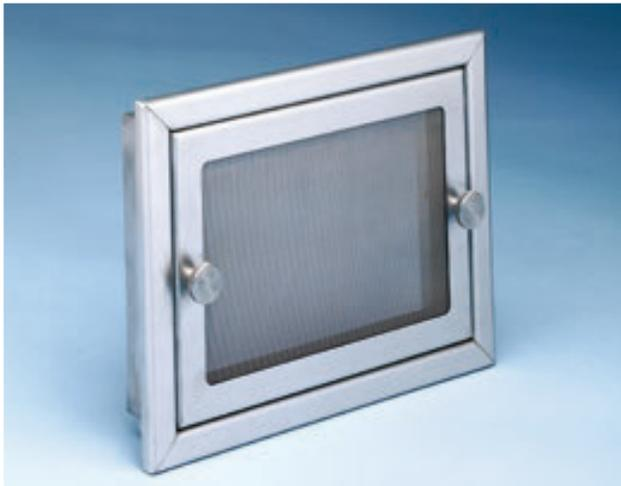
Die stabilen Edelstahlrahmen der Flusenfilter sind aus einem Stück gearbeitet und mit einem engmaschigen Drahtgewebe gemäß DIN ISO 4783 hinterlegt. Maschenweite 0,5 x 0,32 mm. Gesicherte Rändelschrauben aus Edelstahl befestigen den Aufnahmerahmen (20 mm Bord, zusätzlich 10 mm Rückkantung). SL-Flusenfilter entsprechen den Anforderungen der DIN 1946, Teil 4.
